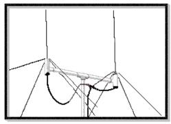
THE ANTENNA RADIATES IN THE DIRECTION OF THE GROUND PLANE THAT'S ATTACHED TO THE LONGEST PHASING LINE.
